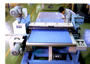
丸ナイフ裁断機 幅1000mmまでのゴム、スポンジ、プラスチッ クを一度に、多量に同型で裁断。 コストダウンとカスタム仕様に迅速な対応。
