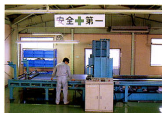
100tプレス ピク抜型を1日で製作できるシステムを確立し、 ゴム、スポンジ、プラスチックフィルム等を多面 どりでピク抜加工。
