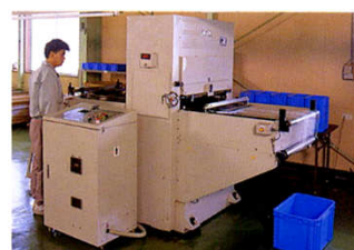
55tプレス コストセーブと迅速な対応に應えるための、小 ロット用ピク抜き、裁断機。生産効率の追求と安 定供給体制を保障。
