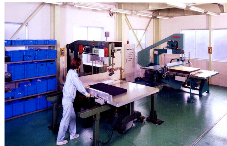
バーティカル・カッティングマシン セッティング・ブロック等の厚みのある材料を大 量にカット。自動式バーティカルと手押し式バー ティカルを配備。
