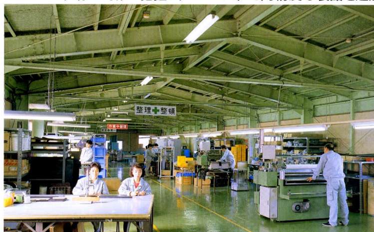
短納期、小ロット対応 ゴム、スポンジ、プラスチックフィルム製造ライン ゴム商社としての永年の仕入ルートを生かし、ローコストで、きめ細かな ニーズへの対応を目的とした、裁断、型抜き、粘着、および接着加工の製造 ライン。
